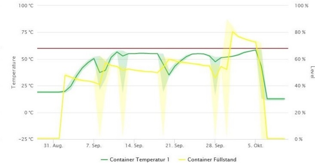
Abbildung A.1: Temperaturverlauf und Füllstand des HyCo während der Befüllung mit Inhalten aus Trockentoiletten der Finizo GmbH, Eberswalde.
