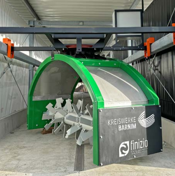
Blick in das hier gerade errichtete Humusregal mit Wendemaschine. | Foto: Gnauk
