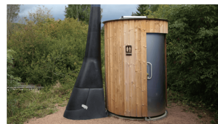
Eine öffentliche Trockentoilette an der Sohanzenanlage Alte Ruh in der Stadt Ruhla im Thüringer Wald. Trockentoiletten funktionieren ohne Wasser, ohne Chemie und ohne Anschluss an die Kanalisation. (imago / Zoonar / Axel Kammerer)
