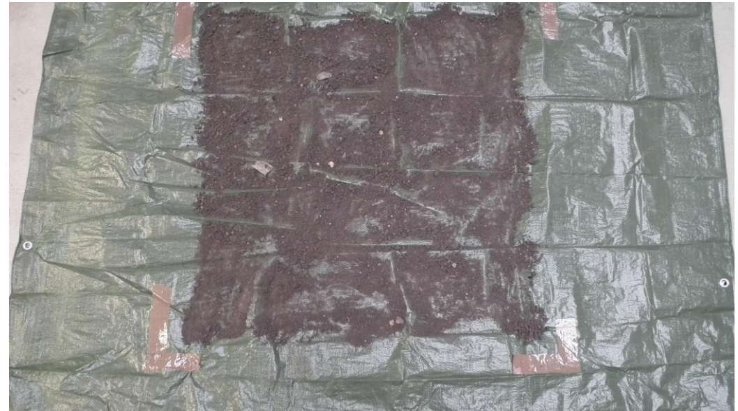
Probe 2 nach Trocknung ausgebreitet auf 1 m 2
