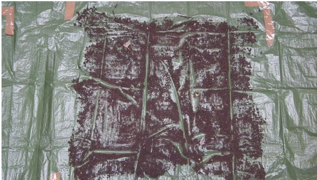
Probe 1 nach Trocknung ausgebreitet auf 1 m 2
