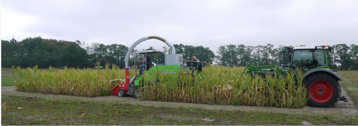
Mit dem Parzellen-Mähdrescher werden die Maispflanzen geerntet. Foto: J-O. Boness
